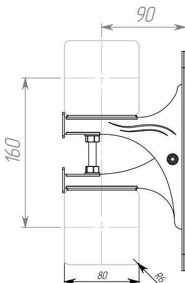
\* Применяется для балансировочных коллекторов BM-60, BM-100, BM-150 с расстоянием между корпусами коллекторов не более 80 мм
