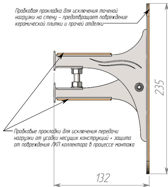
1. Крепление коллекторов BMK-60, BM-60, BM-100, BMKSS-60, BMSS-60, BMSS-100 межосевым расстоянием 125 мм и корпусами сечением 60x60
